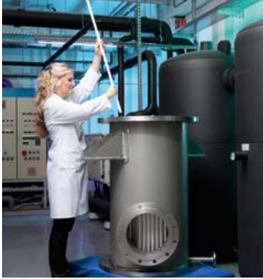
Bestückung eines Moduls mit Zeolithmembranen für die industrielle Entwässerung von Bioethanol
