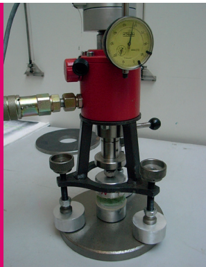
Abb. 7: modifizierte Haftzugprüfung an doppelseitig verklebter Sandwichscheibe (Elastikmasse-Linerharz)
