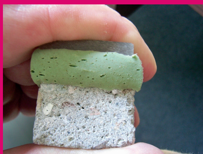
Abb. 2–3: Typischer Aufbau einer Ringspalt-Verfüllung (GFK-Liner-Anbindung) Mechanisch vorbehandelter Untergrund (Beton) – elastische Fugenmasse PUR – Liner
