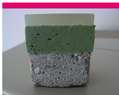
Abb. 2–3: Typischer Aufbau einer Ringspalt-Verfüllung (GFK-Liner-Anbindung) Mechanisch vorbehandelter Untergrund (Beton) – elastische Fugenmasse PUR – Liner
