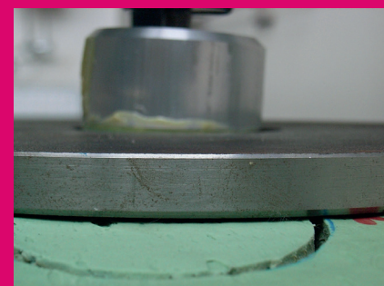
Abb. 4: Zugdehnung 11 mm (Stahlplattendicke) bei 9-mm-Material-Schichtstärke 2K-PUR
