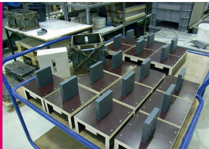
Abb. 5: Massenproduktion Prüfkörper DIBt-Fuge
