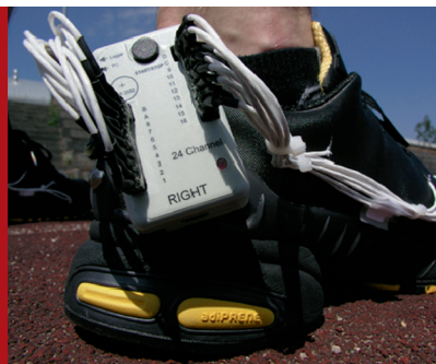
Abb. 1: Messsystem mit Datenlogger zur Funktionsanalyse eines Laufschuhs
