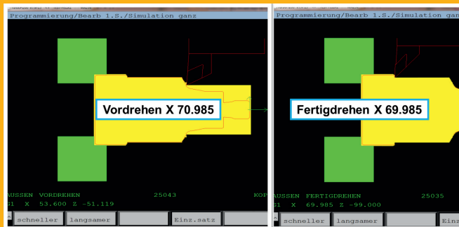
Abb. 7 (links): CNC-Programmiersystem mit importierter CAD-Dreh-Kontur
