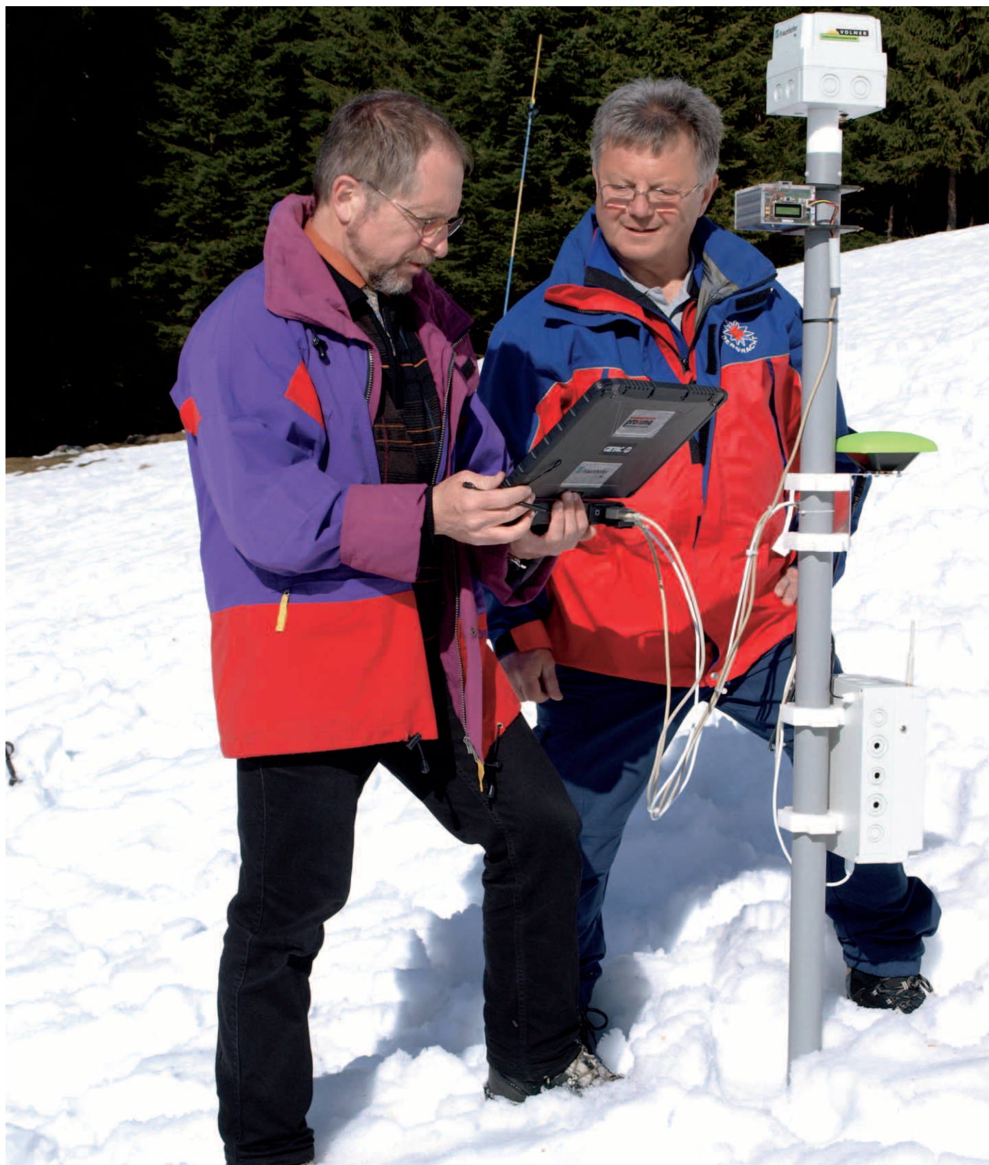
Abb. 4: Prof. Dr. Wolfgang Mayr (li.) zusammen mit einem Mitglied der Bergwacht Berchtesgaden beim Praxistest an der Mittelstation der Jennerbahn. Bei dem an einem Kunststoffrohr befestigten Testsystem befindet sich in dem unten angebrachten rechteckigen Behälter der Empfänger des DGPS-Systems sowie das zum Digitalisieren verwendete USB-Oszilloskop. Das grüne, pilzförmige Gebilde in der Mitte ist die DGPS-Antenne, darüber auf der linken Seite der elektronische Kompass mit den Neigungssensoren. Ganz oben ist die 3D-Antenne zum Empfang der Signale des vergrabenen LVS-Gerätes. Die Datenverarbeitung unter MATLAB erfolgt in dem von Mayr gehaltenen Laptop. (Foto: ProTime GmbH)
