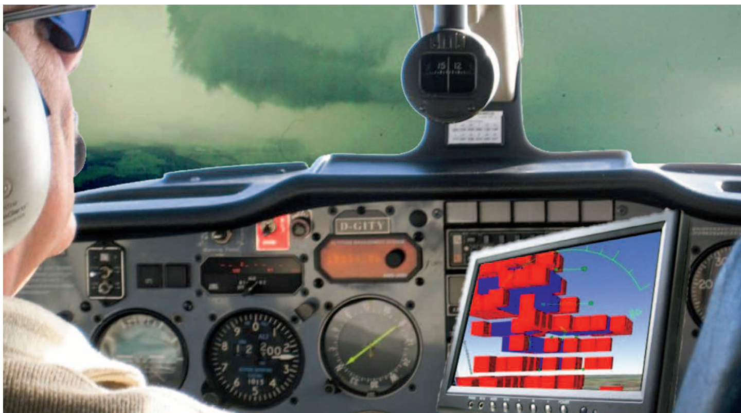
Abb. 4: Pilot im Cockpit mit einem Monitor, auf dem die räumliche Ausbreitung einer Hagelzelle dargestellt ist.
