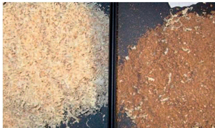
Abb. 4: Ergebnis der Spänentrennung mittels Absaughaube. Das Bild zeigt die deutliche Materialteilung, die allein durch das Trennblech und die beiden Absauganlagen erzeugt wird.
