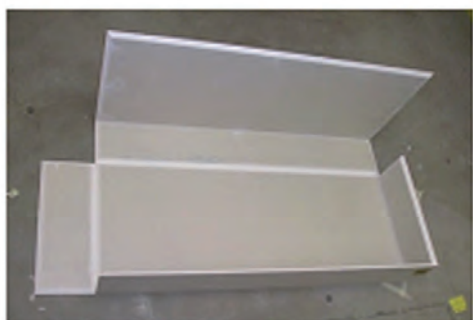
Abb. 2: Der Helmholtzresonator in Form eines Gipskartonkastens.
