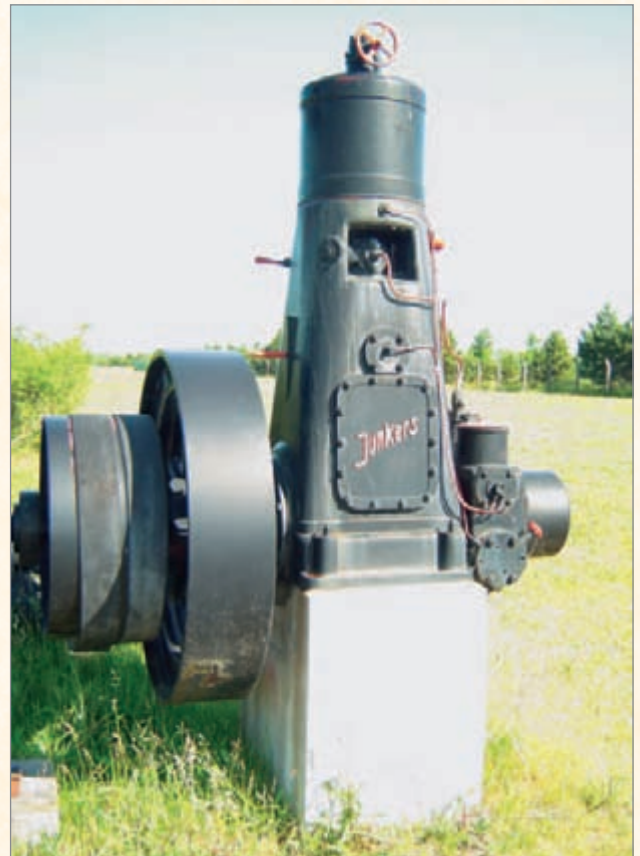
Bild 3: Doppelkolbenmotor zum Antrieb von Abwasserpumpen
