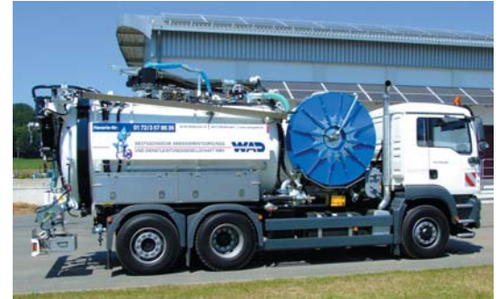
Die turnusmäßige Kanalinspektion erfolgt mit Spülfahrzeugen und Kanal-TV-Technik.
