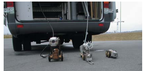
Moderne Leitungsrenovation mit dem Re-Lining-Verfahren im Bereich Schaftriede in Niederwürschnitz. Der zu sanierende Kanalabschnitt wird mit einer Schicht aus Kunstharz ausgekleidet (Foto: IB Dietrich).
