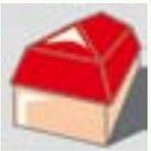
Mansarddächer sichern die größtmögliche Ausnutzung der Dachfläche. Durch diese Dachform werden die Schrägen wesentlich kürzer, die Abseiten als Stellfläche optimal nutzbar. Mansarddächer werden heute nur noch in Ausnahmefällen errichtet.
