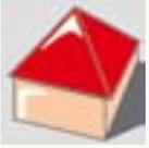
Zeltdächer können nur auf einem quadratischen oder annähernd quadratischen Grundriss errichtet werden. Bei dieser Dachform ist die Symmetrie nach allen Seiten das beherrschende Element: klare und bestimmende Formen und Linien, die in einem Firstpunkt enden. Sie werden mit geringer Neigung oft auf Stadtvillen oder zweigeschossigen Einfamilienhäusern errichtet.
