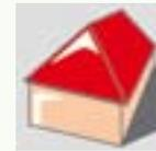
Das Walmdach ist gekennzeichnet durch die an allen Seiten des Gebäudes geneigten Dachflächen, hat seinen Ursprung in der Stroh- und Reetdeckung und wird heute häufig beim Bau von Bungalows verwendet. Kennzeichen der Dachkonstruktion ist die Ausbildung auf den First zulaufender Gänge.
