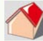
Das Satteldach ist wohl die am häufigsten anzufindende Gebäudedachform. Vorteilhaft ist die wirtschaftliche Konstruktion und die Zweckmäßigkeit, die durch den Flächenzugewinn und die Belichtungsmöglichkeiten aufgrund der senkrechten Giebel besteht.
