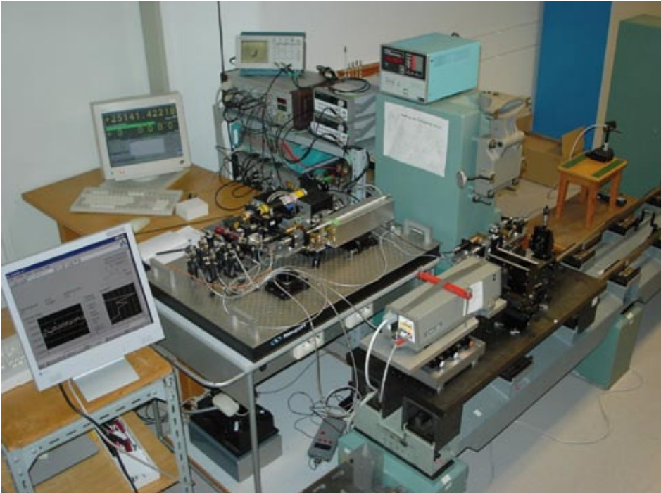
Messungen am 50m-Komparator der PTB Braunschweig. ADI und HP-Interferometer vermessen gleichzeitig die Distanz zu einem über 50m verschiebbaren Retroreflektor.
