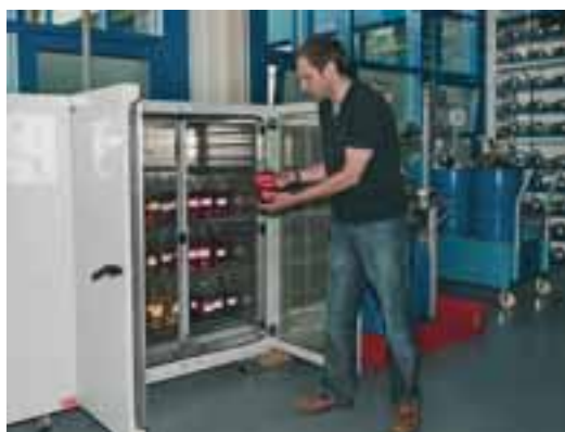
Bioheizöle durchlaufen zurzeit umfangreiche Untersuchungen in Hochschulen, Forschungseinrichtungen und Feldanlagen. Unter anderem konzentrieren sich die Tests, hier am Aachener Oel-Wärme-Institut, auf die Lagerungsstabilität von Heizöl mit unterschiedlichen Anteilen aus nachwachsenden Rohstoffen. Foto: IWO
