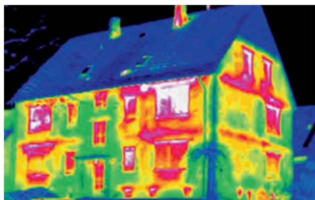
rechts: ungedämmter Altbau mit verschiedenen Schwachstellen.
