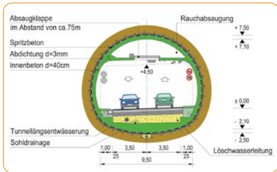
Querschnitt mit Zwischendecke
