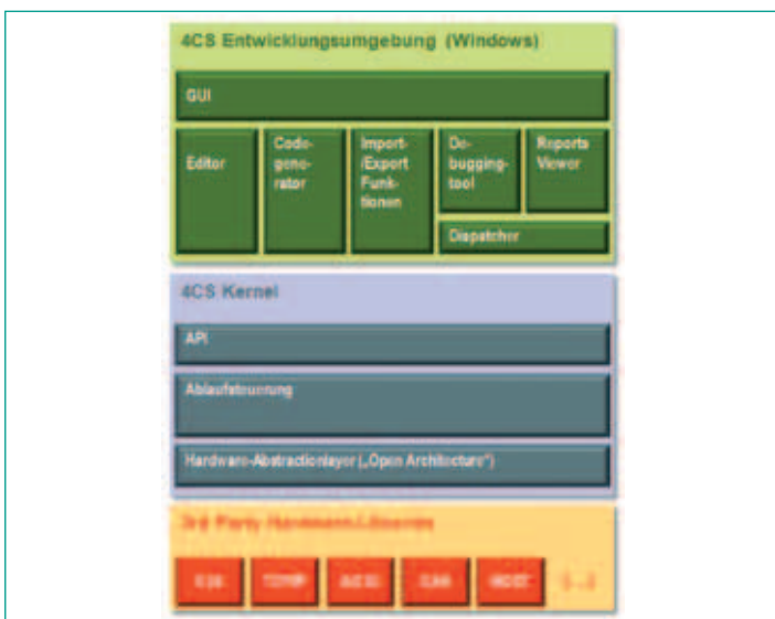
Abb. 3: 4CS-Testsystem bestehend aus 4CS-Entwicklungsumgebung, 4CS-Kernel mit Hardwareanbindung.
