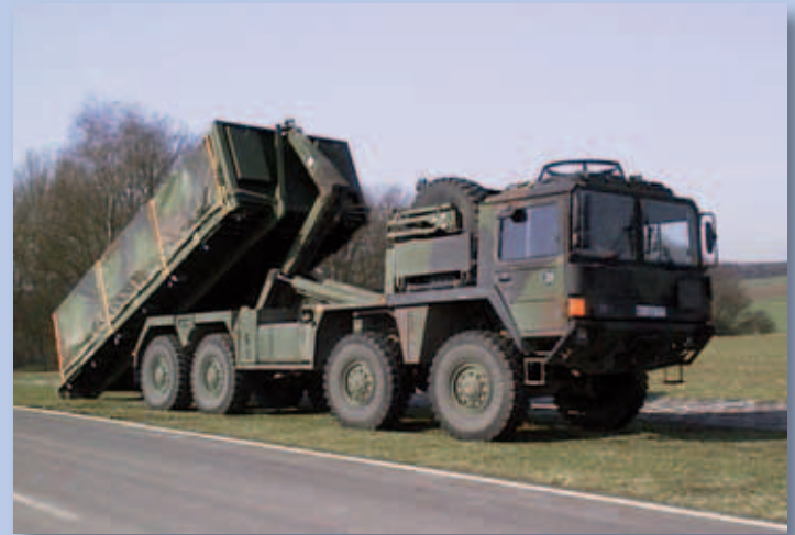
Lastkraftwagen MULTI beim Aufnehmen des Ladebodens
