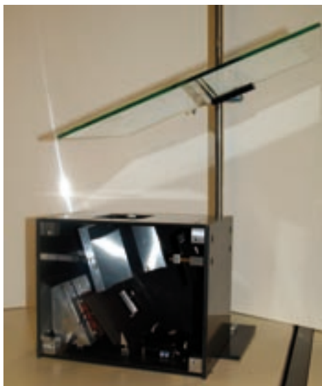
Abb. 11: HUD-Demonstrator der Hochschule Heilbronn mit diamantgefrästem Abbildungsspiegel sowie dessen Integration in den Fahrsimulator
