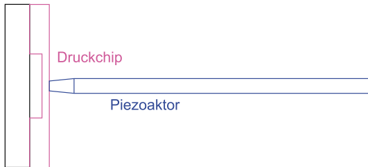
Bild 7: Antriebssystem mit in Membranauslenkungsrichtung frei schwingendem Aktor (Prinzipskizze: vergleiche Bild 6)
