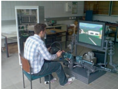
Bild 1: Prüfstands Aufbau zur Entwicklung von aktiven Fahrwerksystemen mit integriertem Lenksystem. (Quelle: HHN/Meroth)
