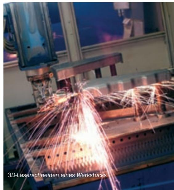
3D-Laserschneiden eines Werkstücks
