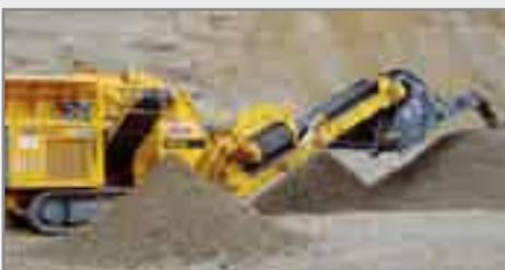
**Recycling statt Entsorgung: Mit RUBBLE MASTER lassen sich Baurestmassen kostengünstig zu einem hochwertigen Endprodukt aufbereiten.**
