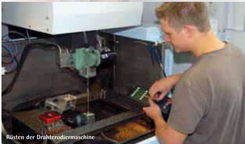
Rüsten der Drahterodiermaschine
