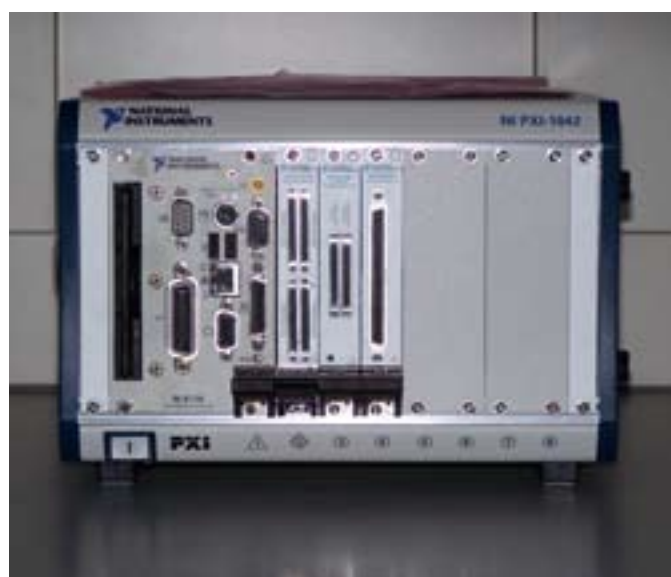
Abbildung 3: Industrie-PC zur Steuerung, Regelung und Messdatenerfassung
