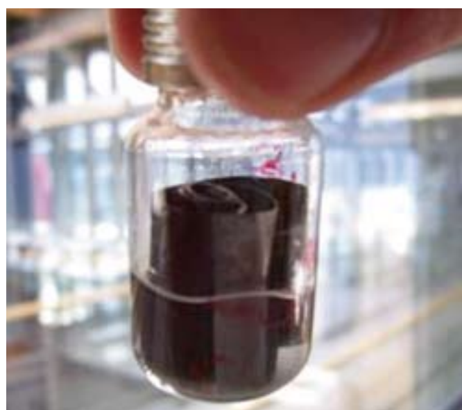
Abb. 2: Eine mit Aktivkohle beschichtete Aluminiumelektrode eines Superkondensators muss im Langzeittest ihre chemische Stabilität und Tauglichkeit erweisen.
