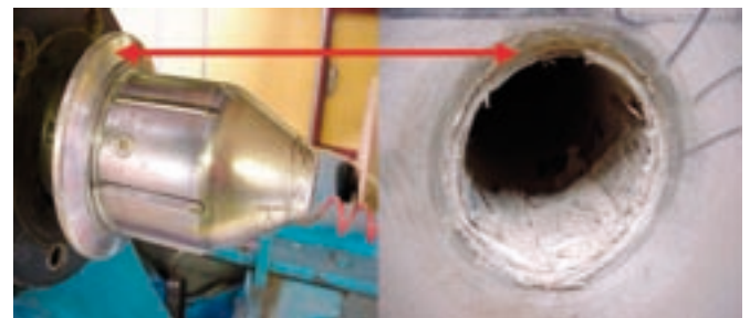
Abb. 2: Beschädigung der Hülse und der Papierrolle
