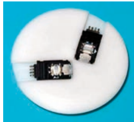
Abbildung 1: Sondenträger „UFO“, bestückt mit zwei SIMAF Sensoren
