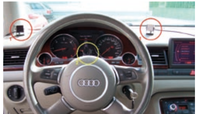
Abbildung 1: Aufbau des DSS-R Systems bestehend aus 1. zwei IR-Beleuchtungsmodulen (rot) und 2. einer IR-Kamera (gelb)
