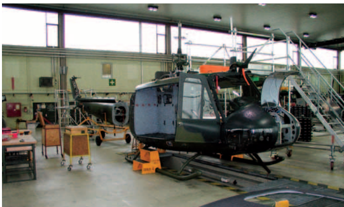
Bell UH-1 D in der Instandsetzungshalle
