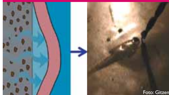
Abb.3: rückseitige Durchfeuchtung → Osmoseblase
