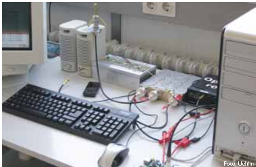
Bild 6 Testaufbau der GSM Mobilfunkzelle
