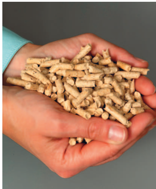
Zertifizierte Holzpellets bestehen nur aus gepressten Sägespänen – ohne jegliche Zusätze
