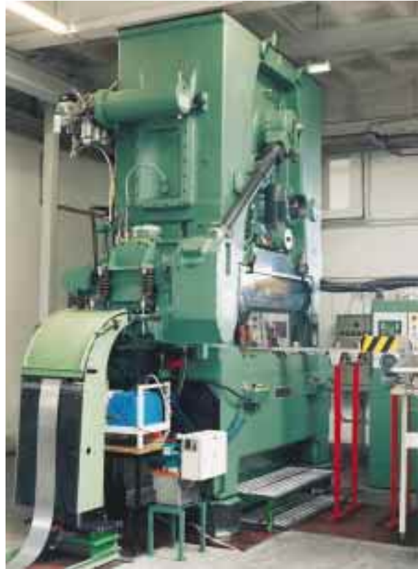
1600 kN – Bruderer Stanzautomat
