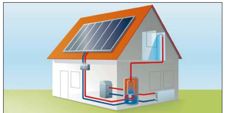
Prinzip einer Solaranlage zur Wassererwärmung und Heizungsunterstützung
