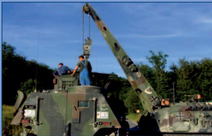
Ziehen eines Triebwerks aus einem TPz Fuchs
